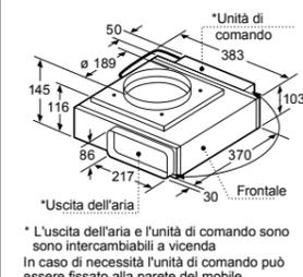
\* L'uscita dell'aria e l'unità di comando sono intercambiabili a vicenda. In caso di necessità l'unità di comando può essere fissato alla parete del mobile.
