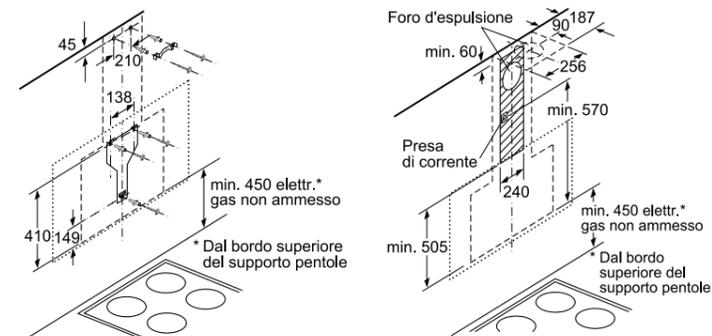
Disegni tecnici Cappa a muro Design inclinato Serie 6
