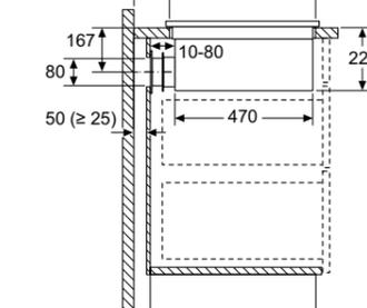
Se si effettua l'installazione direttamente contro pareti esterne non coibentate ( $\mu \geq 0,5 \text{ W/m}^2 \cdot \text{C}$ ), consigliamo di usare configurazioni con ricircolo parzialmente o completamente canalizzato.
