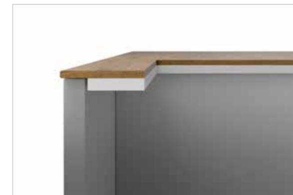
Se il piano di lavoro fosse più sottile di 16 mm, il piano cottura potrebbe comunque essere installato facilmente. Basterà assicurarsi di avere una profondità di almeno 16 mm nell'area di installazione.
