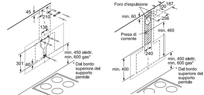
Disegni tecnici Cappa a muro Design inclinato Serie 2
