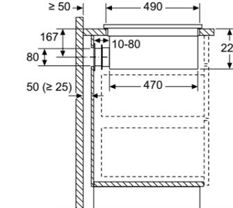
Se si effettua l'installazione direttamente contro pareti esterne non coibentate ( $\mu \geq 0.5 \text{ W/m}^2 \cdot \text{°C}$ ), consigliamo di usare configurazioni con ricircolo parzialmente o completamente canalizzato.
