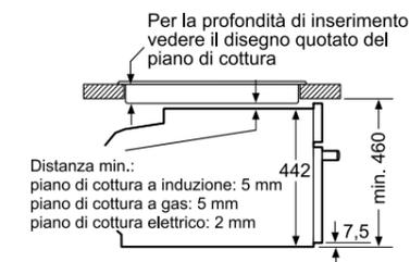
**Disegni tecnici Forni compatti da incasso a microonde Serie 8 (45 cm)**
