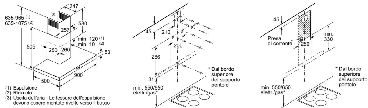
Disegni tecnici Cappa a muro Design piramidale Serie 2
