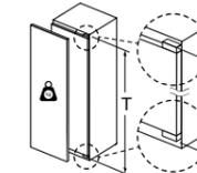
Le ante del mobile montate che superano il peso consentito possono causare danni e anomalie di funzionamento alla cerniera.
