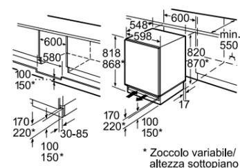
Spazio per il collegamento elettrico a destra o a sinistra dell'apparecchio.
