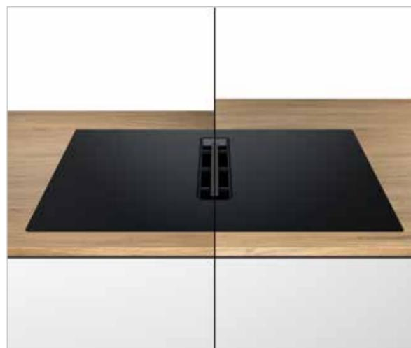
L'installazione dei sistemi a ricircolo senza tubi è possibile per i piani di lavoro profondi 600 mm, per arrivare ad almeno 700 mm per i sistemi a ricircolo con tubatura parziale o completa.
