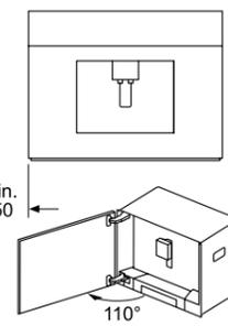
Utilizzando il limitatore di cerniera per una apertura a 92° (ricambio 00636455), la distanza minima al muro può essere di solo 100 mm
