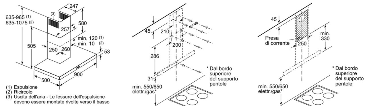
Disegni tecnici Cappa a muro Design piramidale sottile Serie 4
