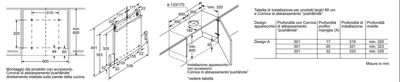
**INSTALLAZIONE CON MODULO CLEANAIR PER CAPPE 90 CM E 60 CM**
