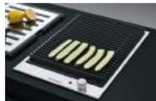
A funzionamento elettrico, con roccia lavica, assorbe grassi ed evita la formazione di fumi. La resistenza è posta sotto la griglia per evitare che il contatto tra essa e i liquidi di cottura generino fumo. La qualità della cottura è analoga alle cotture tradizionali alla brace.
