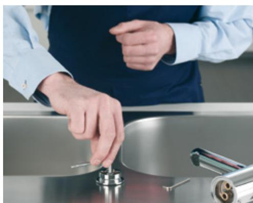
Avvitare, con la prima chiave esagonale in dotazione, il dispositivo di bloccaggio. La base è ora fissata al lavello.
