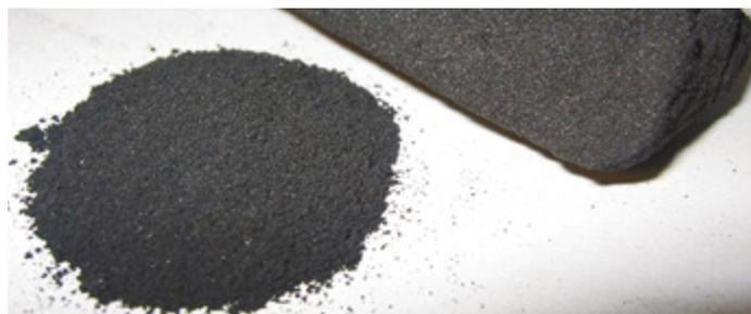
La caratteristica principale del carbone attivo è l'elevata "superficie specifica" dovuta alla sua elevata porosità: ad esempio **un grammo di carbone attivo può arrivare ad avere una superficie interna equivalente a quella di un campo di calcio!**
