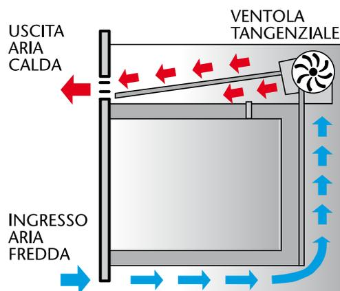
Il sistema di ventilazione tangenziale dei forni TELMA è progettato per evitare il surriscaldamento dei mobili che circondano il vano di cottura. Una ventola, posta all'esterno del vano forno, crea una corrente d'aria continua che riduce la temperatura nella zona attorno al vano stesso ed evita la formazione di umidità e di condensa.
