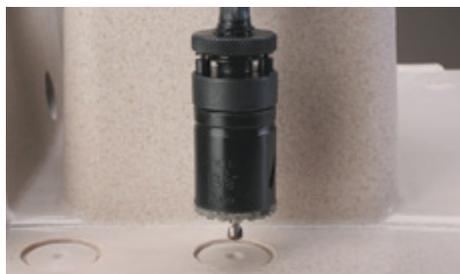
Fig. B - Posizionare la fresa in corrispondenza del preforno
