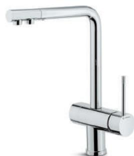
Miscelatore monocomando per lavello con bocca girevole diam. 28 mm **con doppia uscita per acqua depurata**. **Depuratore non incluso**. Flessibili di alimentazione F3/8". Cartuccia da 35 mm a dischi ceramici.
