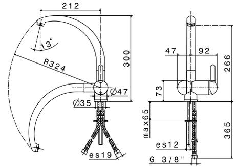
Miscelatore monocomando per lavello con bocca conica girevole **reclinabile** per sotto finestra. Flessibili di alimentazione F3/8". Cartuccia da 45 mm a dischi ceramici.
