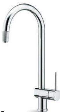
Miscelatore monocomando per lavello con bocca tonda in tubolare girevole e doccia estraibile. Flessibili di alimentazione F3/8". Cartuccia da 35 mm a dischi ceramici.
