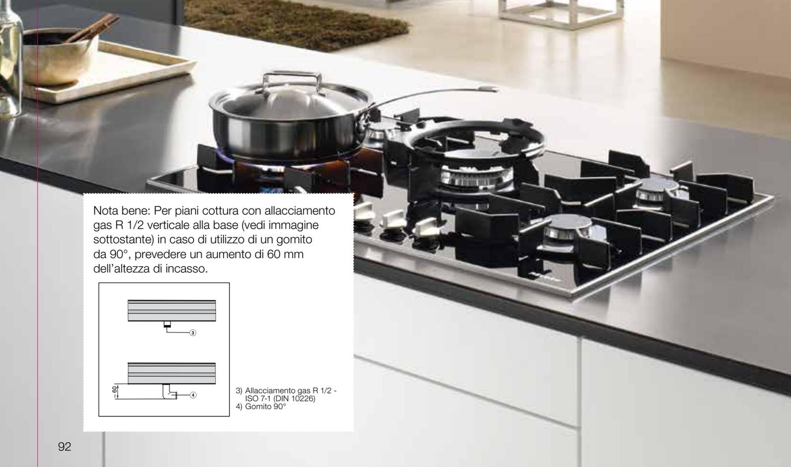
Nota bene: Per piani cottura con allacciamento gas R 1/2 verticale alla base (vedi immagine sottostante) in caso di utilizzo di un gomito da 90°, prevedere un aumento di 60 mm dell'altezza di incasso.
