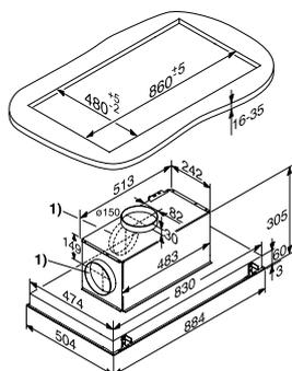
1) Aspiratore ruotabile, i bocchettoni aria si possono montare sopra o ai lati in tutte le direzioni.
