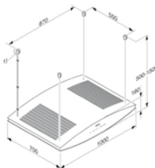
1) cavo di alimentazione, la distanza dal soffitto o dal mobile situato sopra l'apparecchio deve essere di almeno 300 mm.
