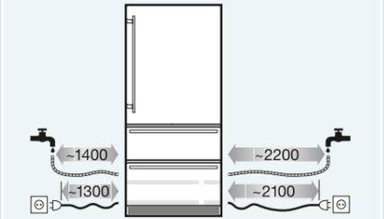
Include il tubo flessibile di 3m per allacciamento dell'IceMaker alla rete idrica (connessione 3/4")
