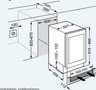
Montaggio sottopiano: piedini regolabili in altezza fino a 50 mm. Ventilazione frontale: non sono necessarie fessure di sfiato sul piano di lavoro. Porta in vetro senza maniglia e cornice. Dimensioni della porta: A: 717 / L: 596 / P: 39 mm
