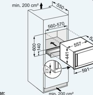
Attenzione: È necessario prevedere un'apertura di aerazione nella base del mobile. Porta isolante in vetro fumè. Dimensioni della porta: A: 455 / L: 591 / P: 16 mm
