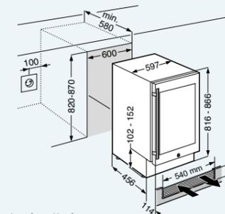
Montaggio sottopiano: piedini regolabili in altezza fino a 50 mm. Ventilazione frontale: non sono necessarie fessure di sfiato sul piano di lavoro. Porta isolante in vetro fumè. Dimensioni della porta: A: 716 / L: 592 / P: 38 mm
