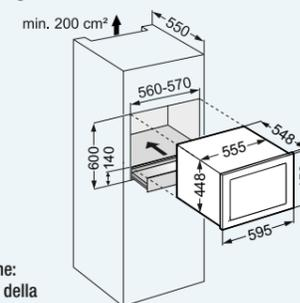
Attenzione: Apertura della porta a ribalta. L'apparecchiatura sfrutta la fessura alla sua base per l'aerazione. Non è necessario predisporre griglie di aerazione alla base del mobile. È comunque necessario lasciare una cavità nel retro del mobile.
