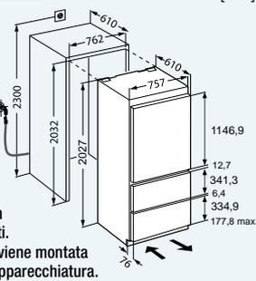
**Attenzione:** Apparecchiatura con cerniere autoportanti.
