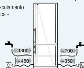
Uscita del cavo di alimentazione dall'alto dell'apparecchiatura.
