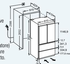
**Attenzione:** Apparecchiatura con cerniere autoportanti. La porta del mobile viene montata sullo sportello dell'apparecchiatura. Le cerniere della porta del mobile non sono necessarie.
