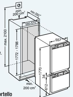
Il peso massimo delle ante non deve superare 18 kg per vano frigorifero e 12 kg per vano completamente estraibile.
