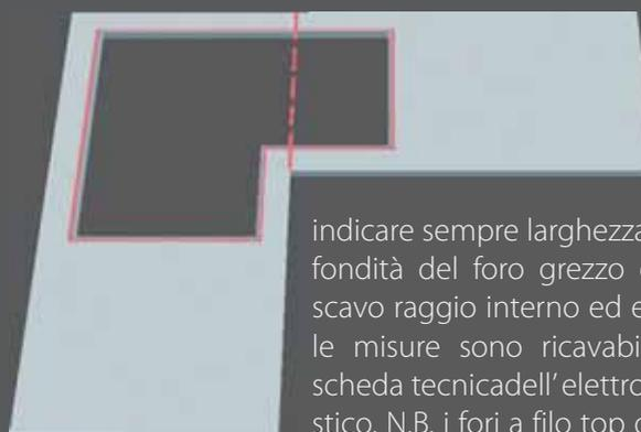
indicare sempre larghezza e profondità del foro grezzo e dello scavo raggio interno ed esterno, le misure sono ricavabili dalla scheda tecnica dell'elettrodomestico. N.B. i fori a filo top devono essere realizzati con le tolleranze indicate dai marchi produttori.
