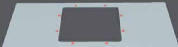
Le posizioni nel disegno sono puramente indicative. Indicare sempre la collocazione delle bussole facendo riferimento alla disegno tecnico del lavello. Fare particolare attenzione che la bussola non ostacoli l'armatura dei mobili sottostanti.
