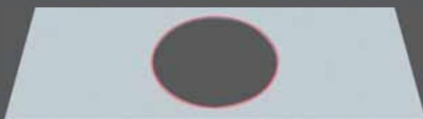
indicare sempre larghezza e profondità del foro grezzo e dello scavo raggio interno ed esterno, le misure sono ricavabili dalla scheda tecnica dell'elettrodomestico. N.B. i fori a filo top devono essere realizzati con le tolleranze indicate dai marchi produttori.
