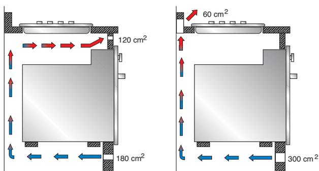
Per un corretto funzionamento del forno a gas assicurarsi che esista una sufficiente circolazione dell'aria di raffreddamento all'interno del vano incasso. L'installazione andrà eseguita in accordo con la figura A o in accordo con la figura B.
