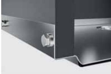
Le pareti di contenimento sono piegate e saldate negli angoli per garantire la tenuta all'acqua e facilitare l'installazione delle lastre che compongono la vasca
