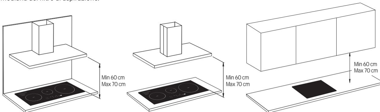
Per i sistemi a soffitto si consiglia di mantenere l'altezza della controsoffittatura ad una altezza non superiore ai 150 cm dal piano di cottura.
