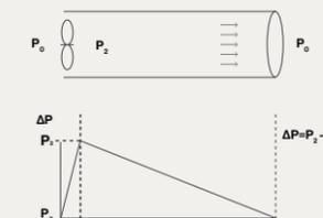
Comportamento del flusso con motore remoto installato in posizione finale.
