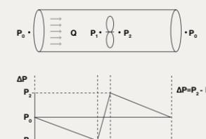
Comportamento del flusso con motore installato in cappa.
